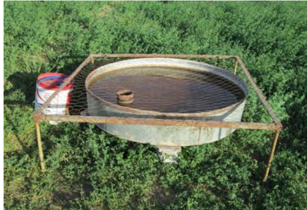
شکل (۱): تشت تبخیر کلاس A واقع در مزرعه یونجه دانشگاه شهید باهنر کرمان
