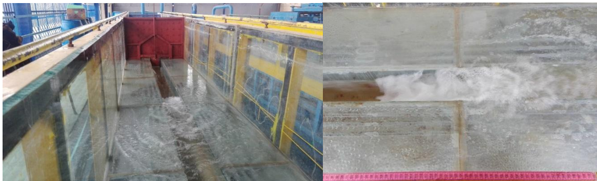
شکل (۳): الگوی پرش هیدرولیکی مرکب در کانال مرکب (عرض نسبی کانال ۰/۲ با عدد فرود اولیه ۶/۱۶ که دارای عمق اولیه ۰/۰۳۴ متر و عمق ثانویه ۰/۱۷ متر میباشد)
