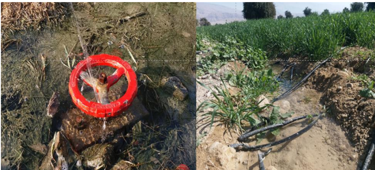
شکل (۵): نوارهای انتها باز و شکستگی شیرفلکه ابتدایی مانیفولد
