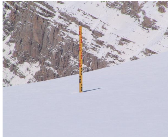
شکل (۲): نمونه‌ای از اشل‌های برف‌سنجی
