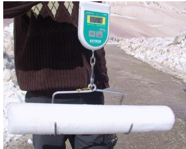
شکل (۳): نحوه توزین برف نمونه برداری شده
