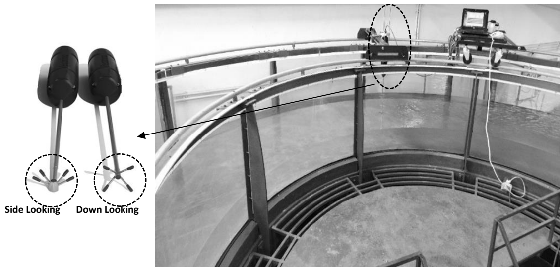
شکل (۴): نحوه استقرار دستگاه سرعت‌سنج Vectrino در قوس ۱۸۰ درجه تند و نمایش probe های side و down looking
