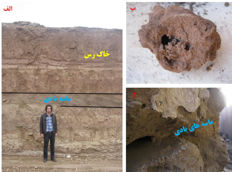
شکل ۱۳. الف) توالی رس و ماسه بادی خیابان وصال ب) نمونه خاک کاملاً رمبنده گرفته شده از عمق ۲ متری شهرک پدر ج) وجود لایه های ماسه های بادی کاملاً ناپایدار در اعماق ۱ متری واقع در خیابان هلال احمر
