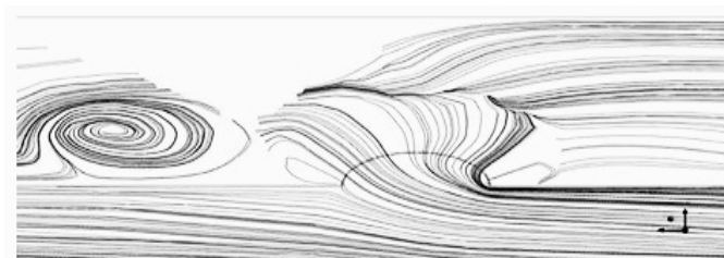
شکل (۱۶): پروفیل خطوط جریان شبیه‌سازی شده در تراز نزدیک تاج سرریز برای سرریز گروه B
