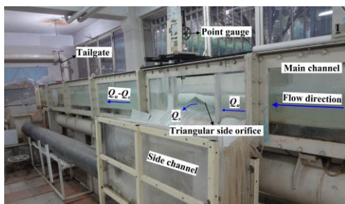
شکل (۲): طرح کلی مدل آزمایشگاهی و روزنه‌های جانبی مثلثی وطن خواه و میرنیا (۱۲)
