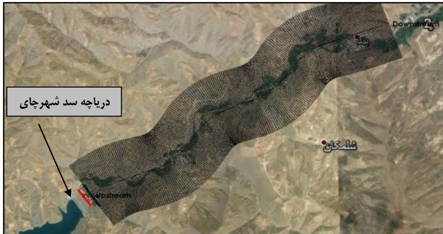
شکل (۷): شبکه‌بندی میدان محاسباتی در مدل عددی CCHE2D با ابعاد \Delta x = 0.4m و \Delta y = 0.8m
