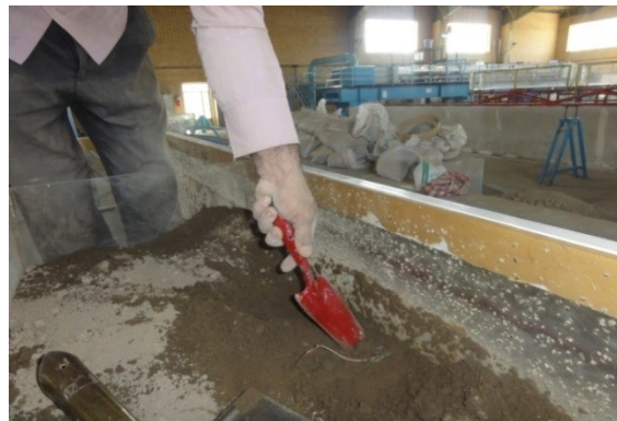
شکل ۲- نمایی از نقاط اندازه‌گیری نیترات در هر محفظه و نمایی از نمونه‌برداری خاک در نقاط مشخص شده پس از انجام آزمایش.
