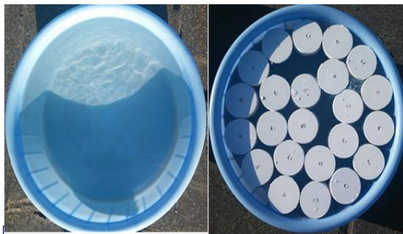
شکل (۱): نمونه شاهد و سطح پوشش داده شده با ماده فونیزه (آزمایش شماره ۱)
