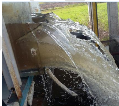
شکل (۹): جریان عبوری از فیوزگیت بعد از واژگونی هر دو واحد (لولا شده)
