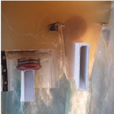
شکل (۸): جریان عبوری از فیوزگیت بعد از واژگونی یک واحد فیوزگیت (لولا شده)
