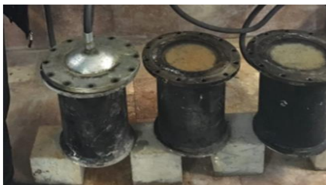
شکل (۵): دستگاه آزمایش نفوذپذیری نمونه‌های استوانه‌ای بتنی
