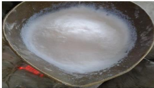
شکل (۲): پودر نانوسیلیس مصرفی در بتن
