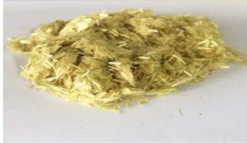
شکل (۱): الیاف کولار مصرفی در بتن
