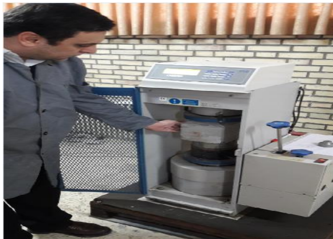
شکل (۳): دستگاه آزمایش مقاومت فشاری نمونه های مکعبی بتنی
