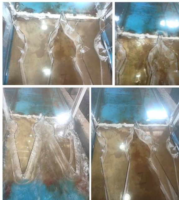
شکل (۵): نمایی از نصب و عملکرد هیدرولیکی شکافنده جریان بر روی سرریز زیگزاگی در تحقیق حاضر
