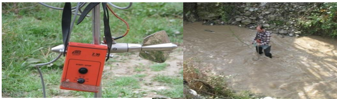
شکل (۲): استفاده از دستگاه سرعت سنج در کانال برای به دست آوردن سرعت جریان آب
