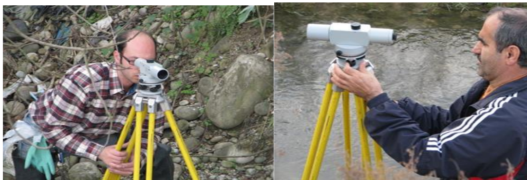
شکل (۲): استفاده از دوربین تراز یاب برای اندازه گیری شیب کانال
