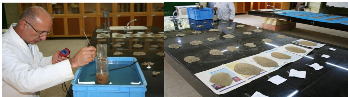
شکل (۳): تعیین دانه بندی خاک در آزمایشگاه مکانیک خاک به روش هیدرومتری
