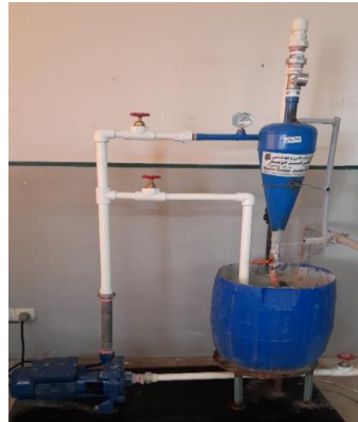
شکل (۱): سامانه آزمایشگاهی: ۱- هیدروسیکلون ۲- فشارسنج ۳- شیر کنترل دبی ۴- الکتروپمپ ۵- مخزن ۶- شیر تخلیه.
