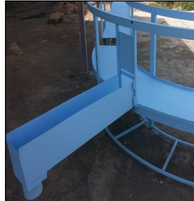
شکل (۲): نمایی از مدل فیزیکی فلوم و آبگیر نصب شده
