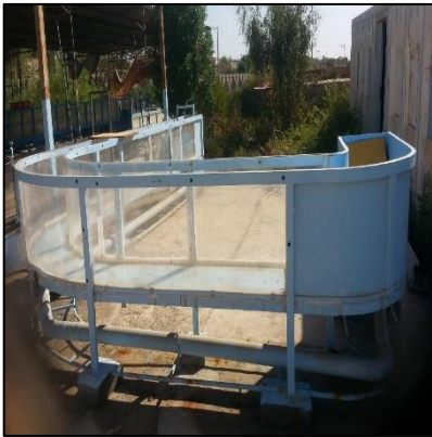
شکل (۲): نمایی از مدل فیزیکی فلوم و آبگیر نصب شده
