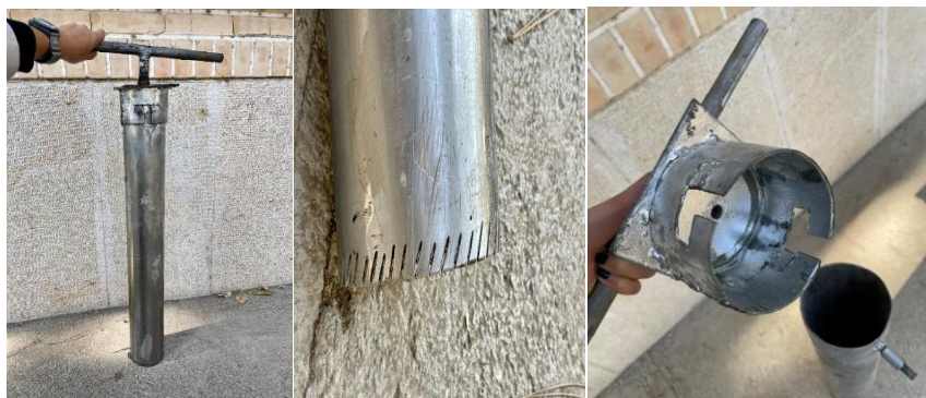
شکل (۲): سیلندر طراحی شده به جهت نمونه‌برداری از خاک عرصه با حداقل دستخوردگی
