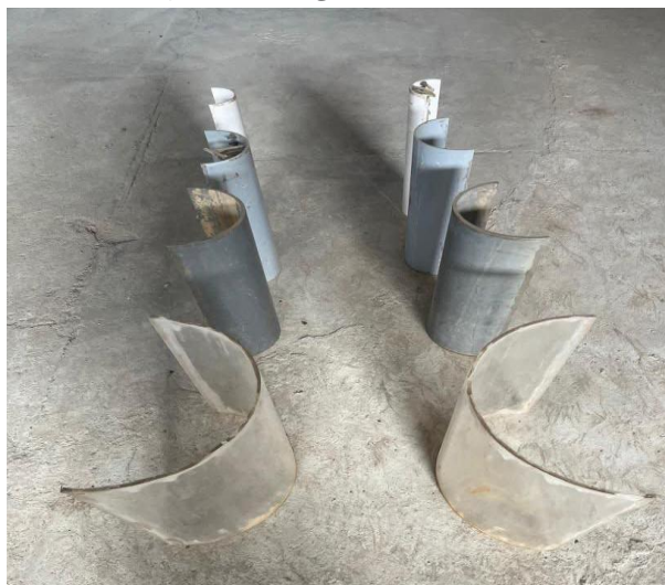
شکل (۳) چهار هندسه متفاوت از نسبت انقباض در فلوم SMBF
