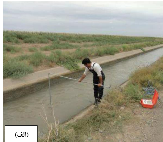
شکل (۴): تحقیقات میدانی شبکه آبیاری مغان (الف) اندازه‌گیری دبی جریان با دستگاه دبی‌سنج (ب) اندازه‌گیری دقت اشل بازشدگی سازه آبیگیر
