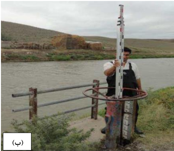
شکل (۴): تحقیقات میدانی شبکه آبیاری مغان (الف) اندازه‌گیری دبی جریان با دستگاه دبی‌سنج (ب) اندازه‌گیری دقت اشل بازشدگی سازه آبیگیر
