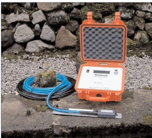
شکل (۵): دستگاه دبی‌سنج مورد استفاده در مطالعه حاضر
