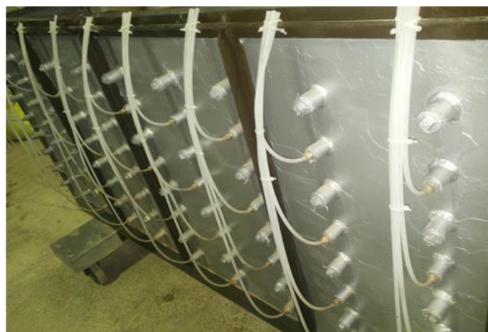
شکل (۳): نحوه اتصال پیزومترها و درپوش‌های روی سطح جانبی مدل
