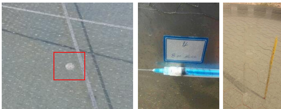
شکل (۳): نمایی از دماسنج دیجیتال جهت اندازه‌گیری دمای آب تشت، سرنگ تزریق مونولایر و پخش شدن مونولایر در سطح آب
