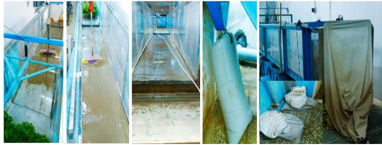
شکل (۲): دریچه تخلیه رسوب، دریچه تنظیم جریان آب، چگونگی جمع آوری رسوب و نمونه‌های جمع آوری شده رسوب.
