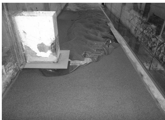
شکل (۶): نمونه‌ای از آبخستگی ایجاد شده در اطراف تکیه‌گاه مستطیلی در تحقیق حاضر
