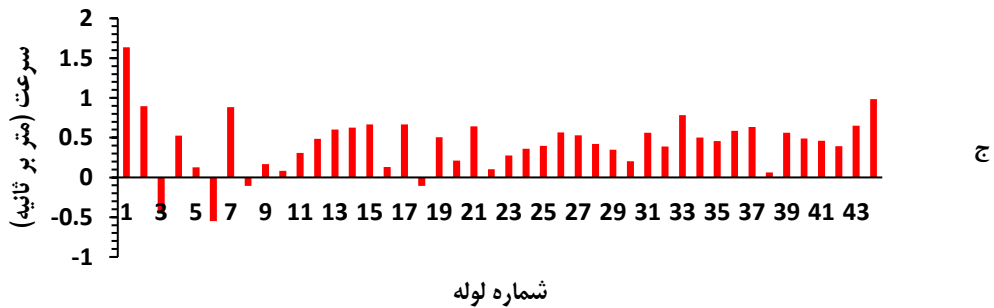
شکل (۵): مقادیر فشار در گره‌ها، دبی و سرعت جریان در لوله‌ها به هنگام ارتباط گره ۱۲ با ۴۱ برای لحظه حداکثر مصرف
