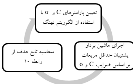
شکل (۱): مراحل تعیین پارامترهای C و sigma با استفاده از الگوریتم بهینه‌سازی نهنگ
