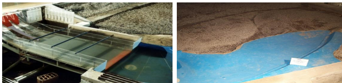
شکل (۲): مدل فیزیکی سیستم تخلیه سیلاب سد نیان در آزمایشگاه مؤسسه تحقیقات آب
