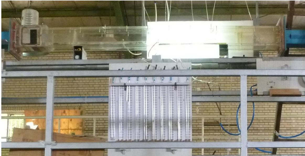
شکل (۲) مقطع آزمایشی تونل آب بر به همراه مانومترهای جیوه‌ای و روتامتر
