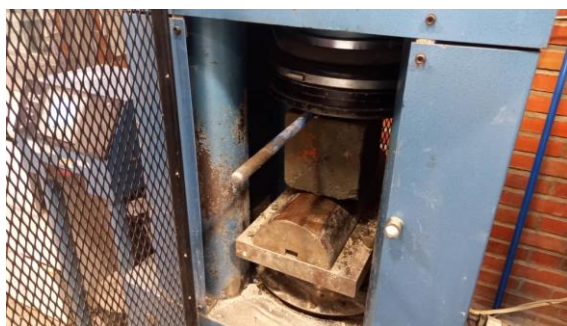
شکل(۲): نحوه اتصال بتن‌های جدید و قدیم و مراحل انجام آزمایش مقاومت کششی
