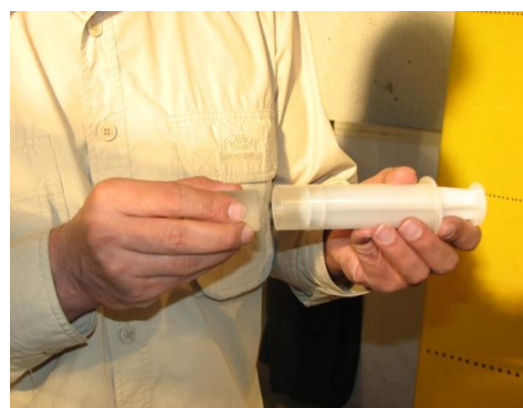
شکل (۱۱): سرنگ جهت مغزه‌گیری از بستر
