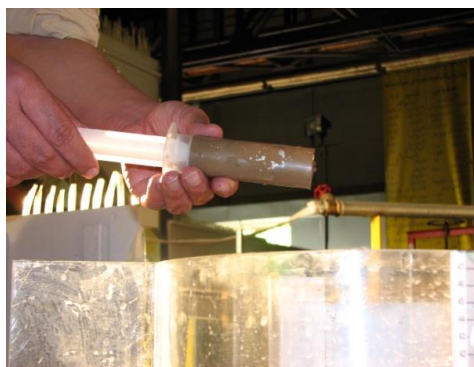
شکل (۱۳): نمونه گرفته شده از بستر در یکی از دوره‌های تحکیم
