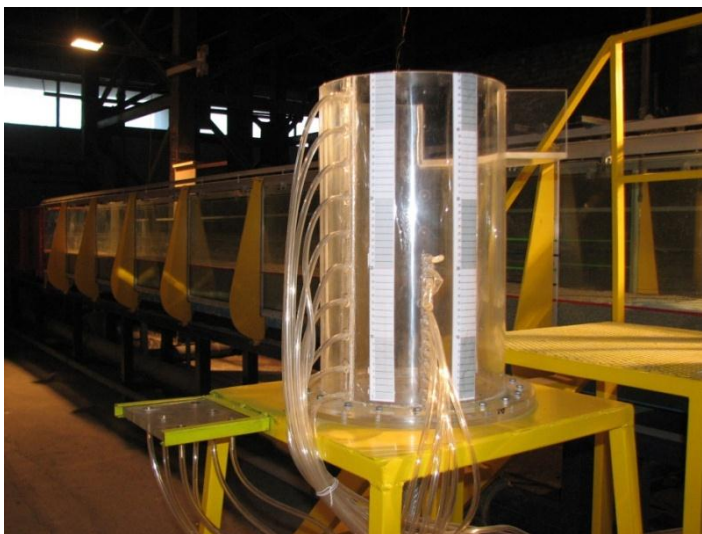
شکل (۳): نمائی از دستگاه استوانه تحکیم
