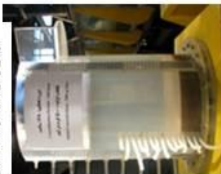
شکل (۷): دوره تعکیم : ۳۸ ساعت، غلظت اولیه : ۵۰۰ گرم در لیتر، ارتفاع رسوبات پستری : ۵/۵ سانتیمتر
