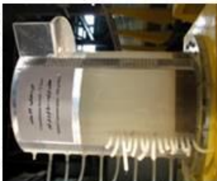
شکل (۳): آغاز رسوبگذاری، غلظت اولیه : ۵۰۰ گرم در لیتر، ارتفاع مخلوط آب و رسوب : ۳۰ سانتیمتر
