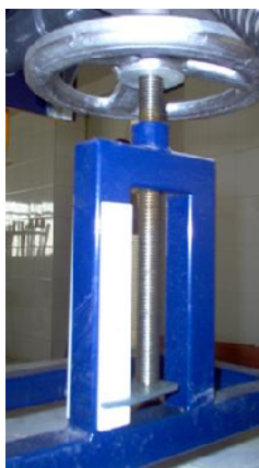
شکل (۳) الف) نمایی از کانال آزمایش، ب) اهرم تنظیم کننده شیب کانال
