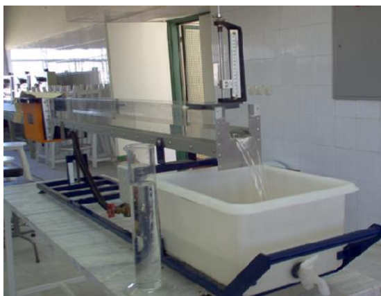
شکل (۳) الف) نمایی از کانال آزمایش، ب) اهرم تنظیم کننده شیب کانال
