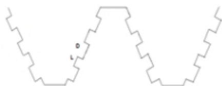
شکل (۴): شکل شماتیک سرریز کنگره‌ای دوزنقه‌ای مرکب دایره‌ای WLCR
