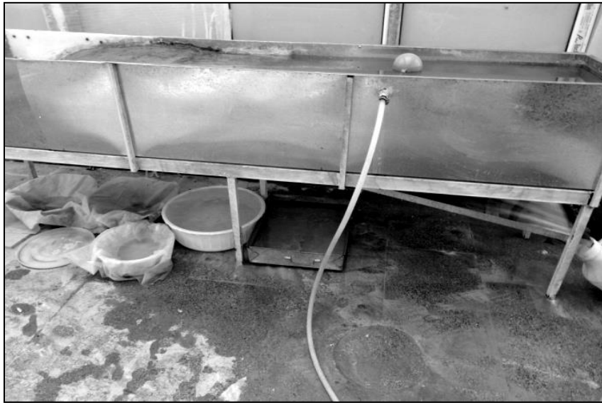
شکل (۵): اندازه‌گیری دبی نشت از بستر و دیواره‌ی آب‌بندان در مدل فیزیکی
