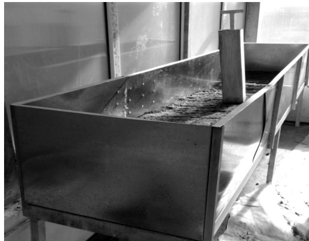
شکل (۳): تصویری از کوبیدن خاک در مدل فیزیکی با چکش تراکم مکعبی
