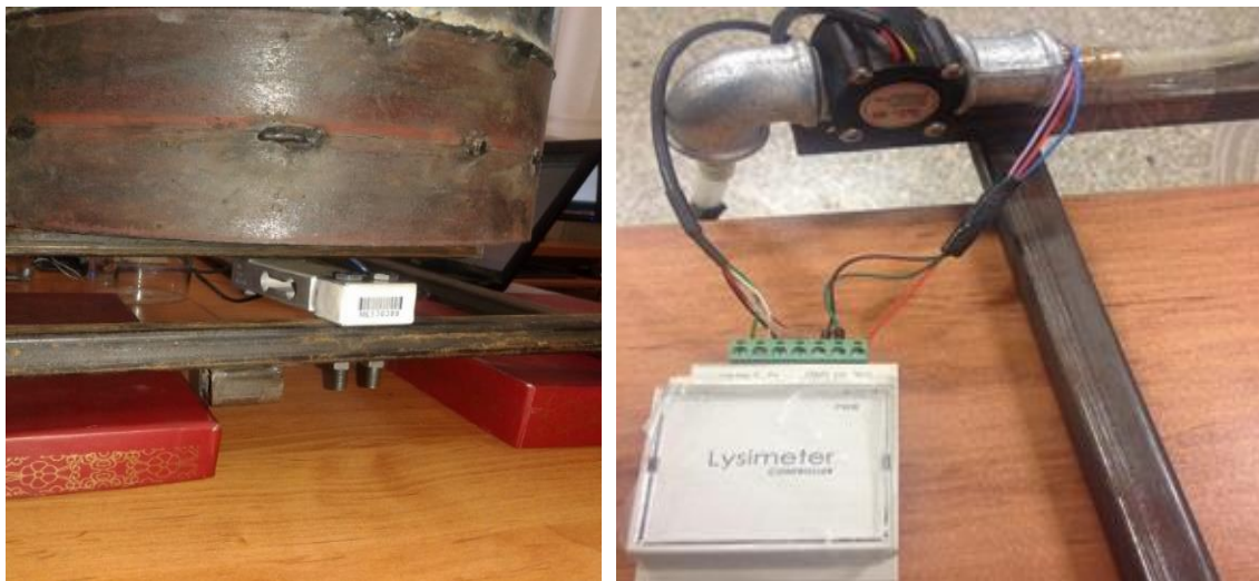
شکل (۴): شمای نصب فلومتر (شکل راست)، پایین مخزن کشت، پایه نگهدارنده و موقعیت نصب سنسور نیرو (شکل چپ)
