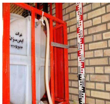
شکل (۱): تانک پلاستیکی و بالابر جهت تامین آب سیستم و فشار مورد نیاز و همچنین نحوه کار قطره‌چکان‌ها
