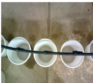
شکل (۱): تانک پلاستیکی و بالابر جهت تامین آب سیستم و فشار مورد نیاز و همچنین نحوه کار قطره‌چکان‌ها
