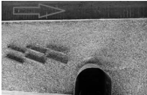
شکل (۹): نمای بالا از پره‌های مستغرق (قرارگیری پره‌ها به صورت دو ردیف موازی)
