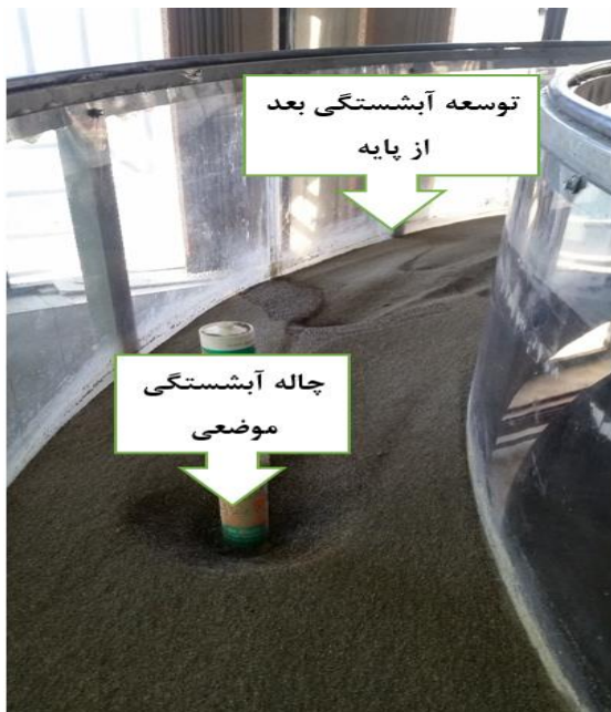
شکل (۴): الگوی آبشستگی موضعی اطراف پایه پل استوانه‌ای در انتهای یک آزمایش
