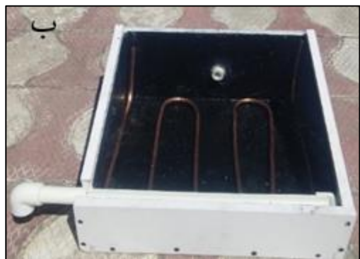
شکل ۲ (الف): ابعاد و طرح شماتیک دستگاه آب شیرین‌کن ساخته شده (ب): عکس دیجیتالی گرفته شده از دستگاه
