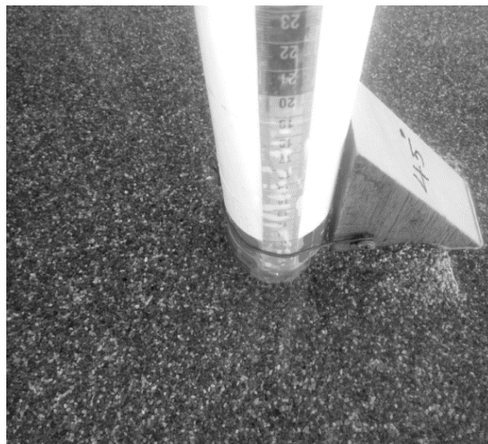
شکل (۸) سازه محافظ ۴۵ درجه در پایین دست
