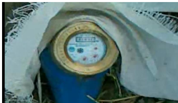
شکل (۵): دستگاه کنتور حجمی جهت اندازه‌گیری حجم آب آبیاری
