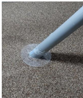
شکل (۳): طرح شماتیک از نحوه‌ی قرارگیری پایه در حالت زاویه‌دار و مدل واقعی پایه‌ی استوانه‌ای همراه با طوقه
