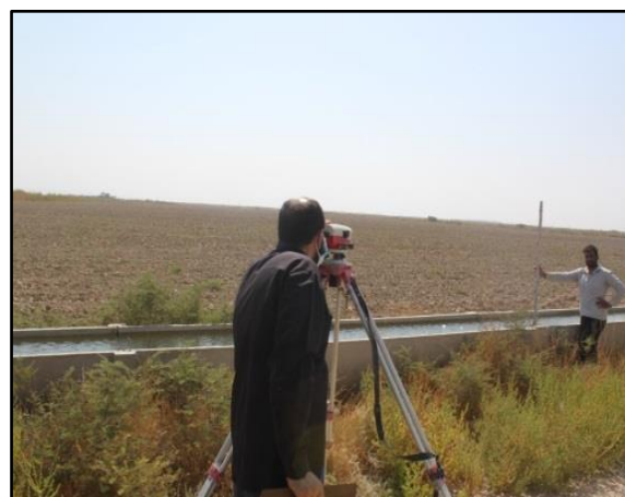
شکل (۶): تراز یاب مورد استفاده جهت اندازه گیری شیب کانالتها
