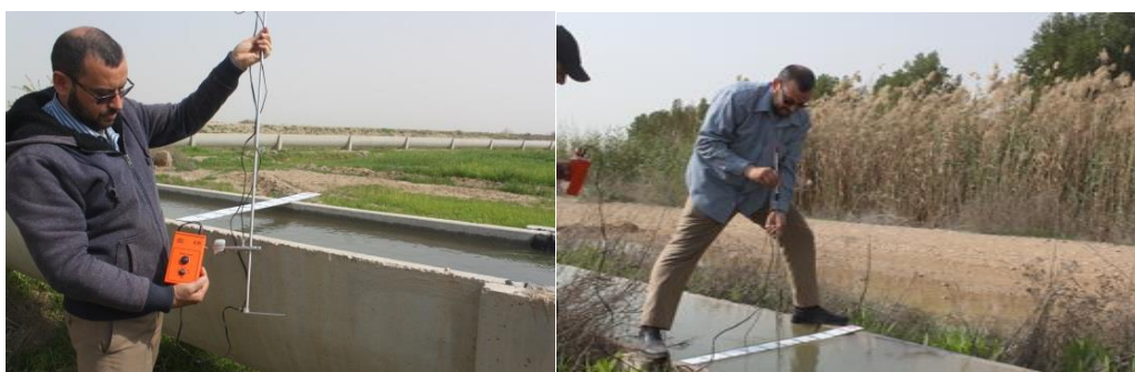
شکل (۵): اندازه‌گیری سرعت جریان در کانال‌های دارای مشکل رسوبگذاری در ساحل چپ شبکه آبیاری و زهکشی شهرستان رامشیر
